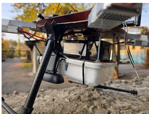
Рисунок 6 – Общий вид экспериментального образца БПЛА с высокой детализацией: рама, шасси, полетный контроллер, штатная система навигации БПЛА, система связи и управления, полезная нагрузка (автономная система навигации)
