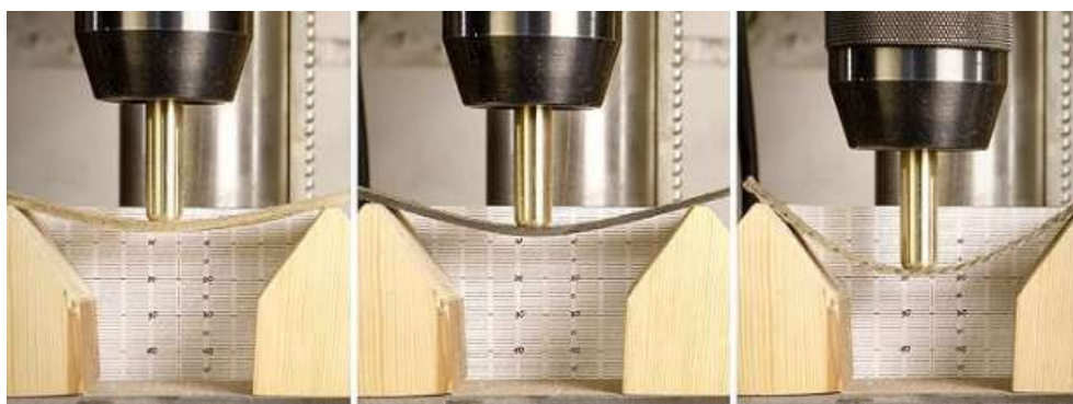
Рисунок 1 – Испытание на стенде композитных материалов на прочность (слева на право: стеклоткань, карбон, кевлар)
