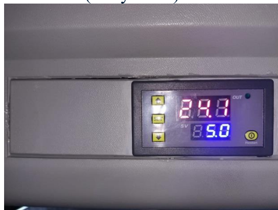
Рисунок 1 – Терморегулятор/термостат в кабине автомобиля КамАЗ 43114
