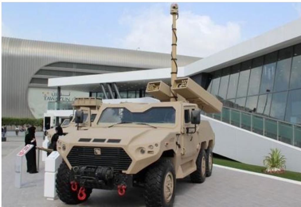
Рисунок 4 - Броневедомобиль NIMR с 16-ю ракетами TALON и двумя противотанковыми управляемыми ракетами
