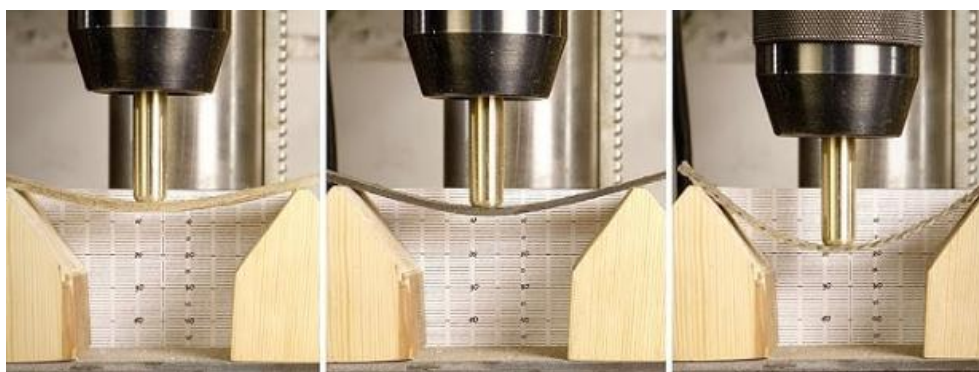
Рисунок 1 – Испытание на стенде композитных материалов на прочность (слева на право: стеклоткань, карбон, кевлар)
