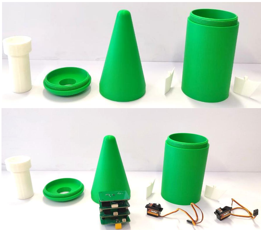
Рисунок 2 - Набор 3D-печатных деталей корпуса БКУ: адаптер, седло и обтекатель, внутренние консоли, приборный отсек
