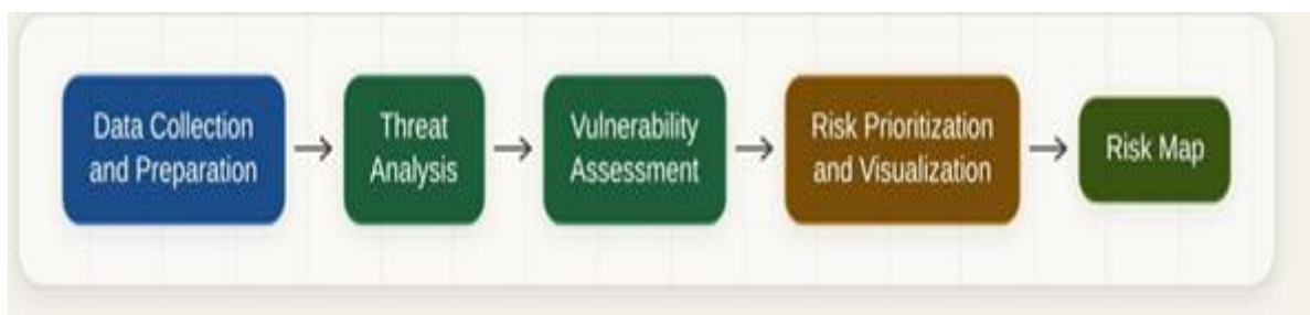
Рисунок 8 - Схема формирования карты риска на основе последовательной обработки пространственных и аналитических данных
