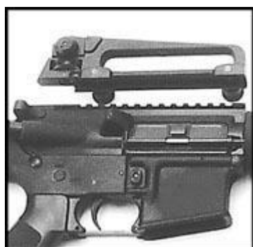
штурмовая винтовка М16А2 с новым утяжеленным стволом, новыми прицельными приспособлениями и измененной фурнитурой (примерно 1985)
