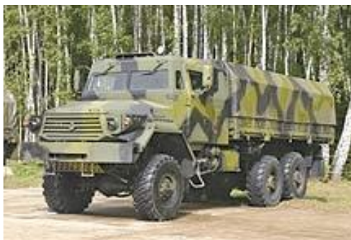
Первенец совершенно нового семейства уральских автомобилей – «Урал-6320» с кабиной модульной конструкции и двигателем ЯМЗ-7511.10
