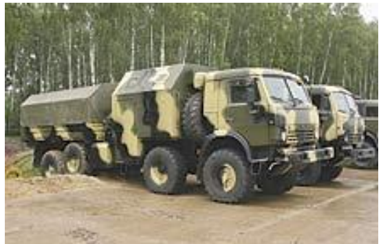
Специальный четырехосный артиллерийский тягач на базе КамАЗ-6350 со скрытым бронированием
