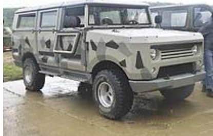
Макет УАЗ модульной конструкции с возможностью скрытого бронирования
