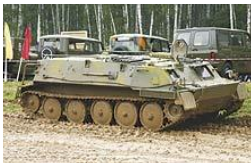
Модernизированный многоцелевой бронированный транспортер-тягач ГАЗ-3402Д с дизельным двигателем Д-245.9
