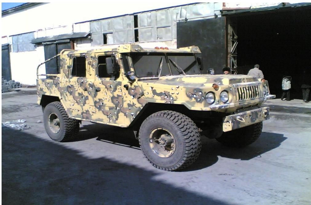
По результатам проведенных испытаний автомобиля «Барс» были сделаны выводы о том, что на раму «ГАЗ-66» требуется свое типовое решение кузова. При проведении работы по созданию своего кузова необходимо было придерживаться следующих требований:
