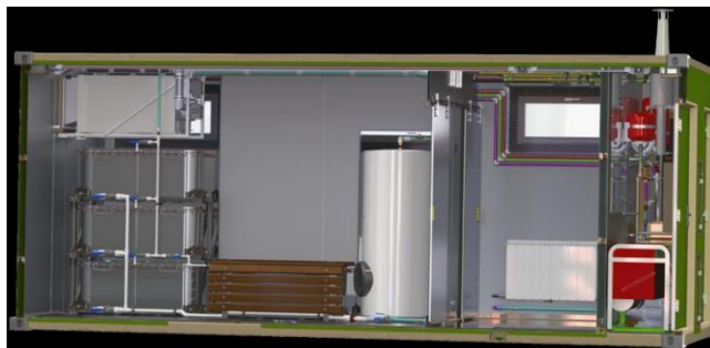
2 сурет - Автономды жылжымалы монша модулі (Украина)
