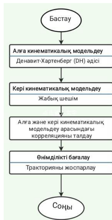
Сурет 3. Кинематикалық модельдеу процесінің блок-схемасы
