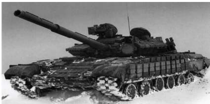
Рисунок 5. Т-64БВ, оснащенный динамической защитой «Контакт-1».
