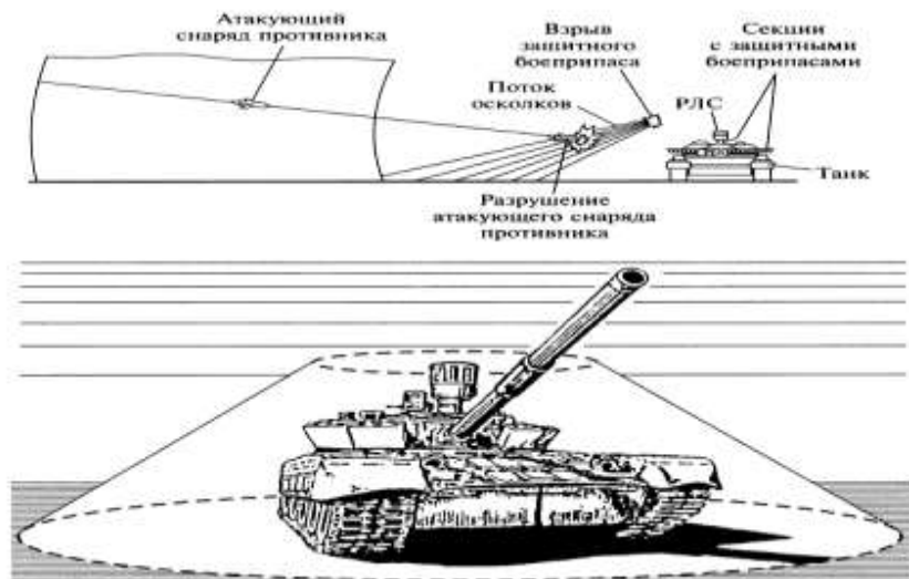
Рисунок 7. Принцип действия комплекса активной защиты.
