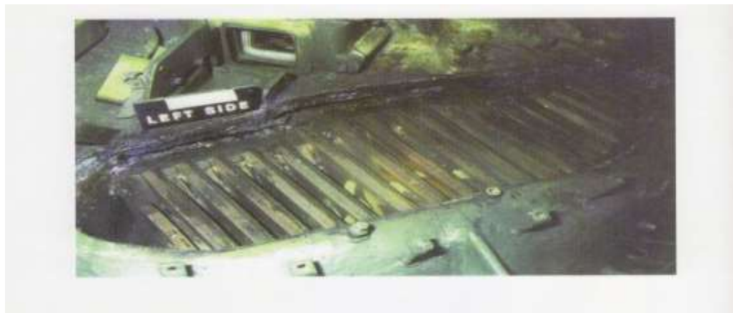
Рисунок 4. Ниша для комбинированной брони башни Т-72Б, в которой располагаются те самые пакеты «отражающих листов».
