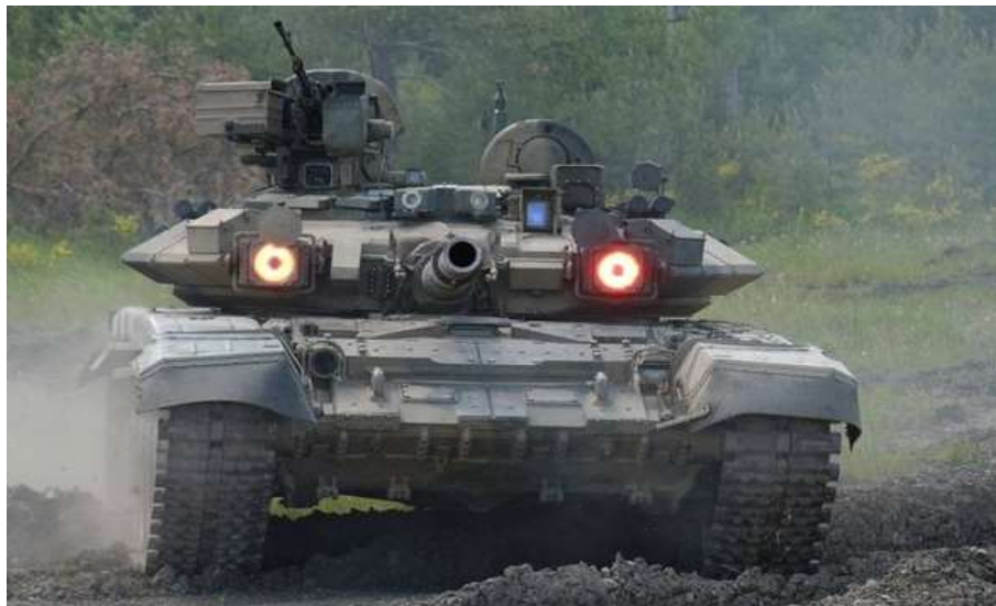
Рисунок 8. Эти «красные глаза» Т-90 и есть прожекторы КОЭП «Штора».
