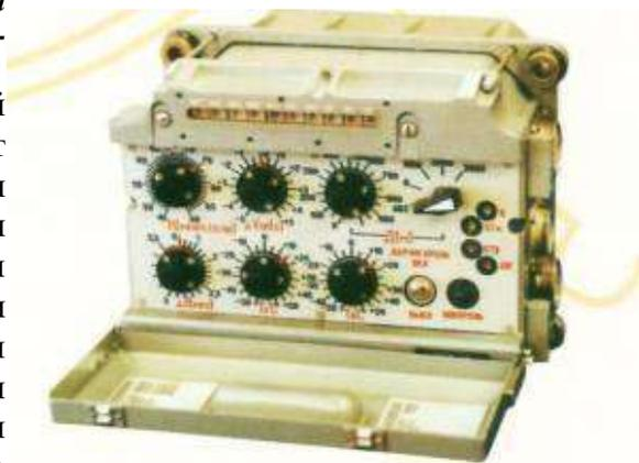
В отличие от СУО ранее выпускавшихся в СССР танков, на Т-90 ТБВ выполняет функцию и блока разрешения стрельбы, другими словами, позволяет замкнуть цепи стрельбы только в том случае, если отклонение оси канала ствола пушки в горизонтальной и вертикальной плоскостях от заданного ей направления не превышают установленного порогового значения.
