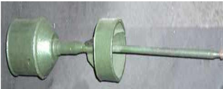
*Фото №1 Винтовочная противотанковая граната Сердюка образца 1941 года - ВПГС-41*
