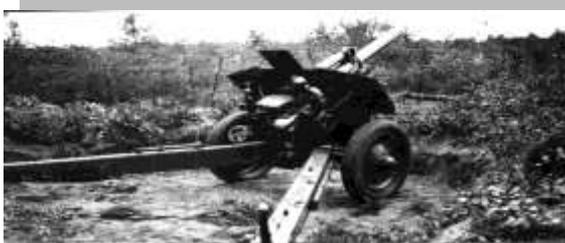
*Рис.1 122-мм гаубица М-30*
