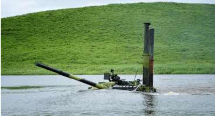
**Рис. 2 Преодоление водной преграды на танке.**
