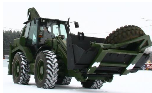
Рисунок 3. Экскаватор бульдозер погрузчик инженерных войск Республики Беларусь
