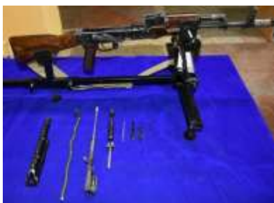
Сурет 2. Әмбебап станогына АК-74 автоматының бөлшектеп орналастыруы
