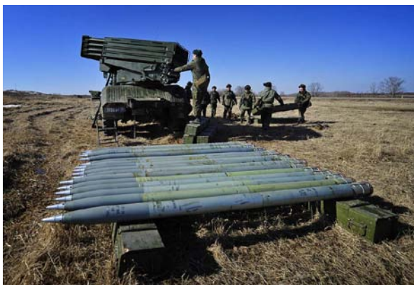
Рисунок 4. Реактивный неуправляемый снаряд с осколочно-фугасной головной частью.
