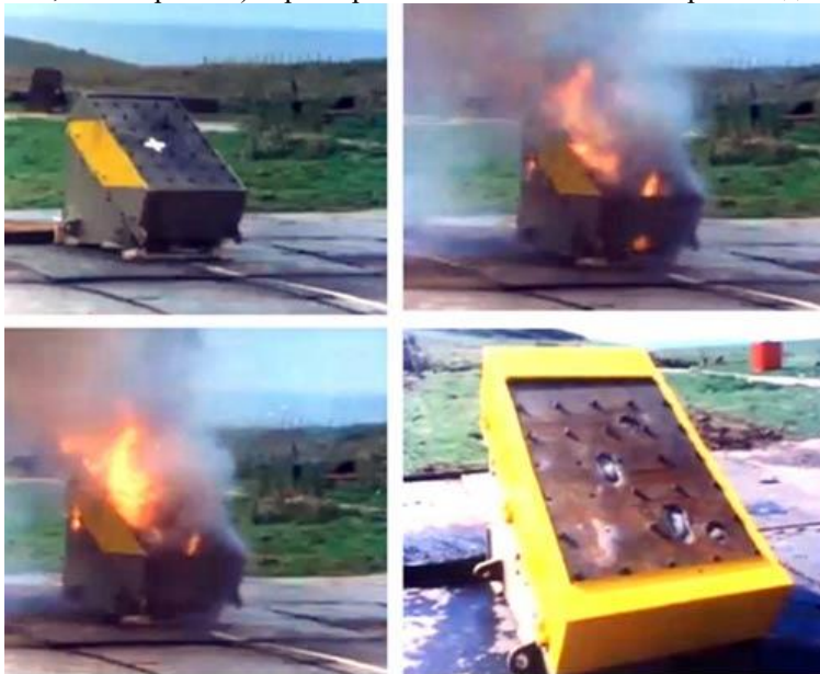
Испытания брони «чобхейм», Великобритания. После попадания атакующего боеприпаса листы пакета деформируются со снижением эффективности, возможны срывы креплений слоев пакета.
