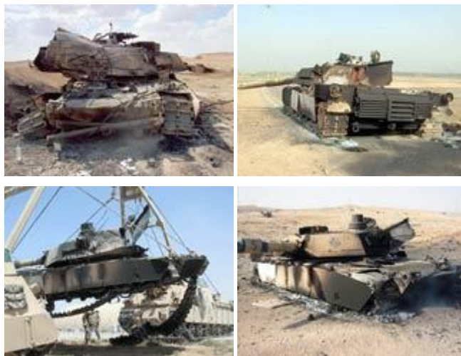
Разрушение кормовой ниши «Абрамса» с вышибными пластинами в результате попаданий ПТС.
