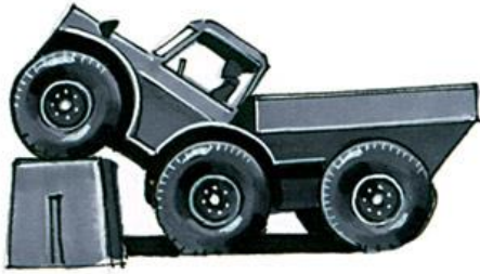
Жол таңдамайтын швецар фирмасы Meileu Metrak көлігі көлденең бөгеттен өтуде.
