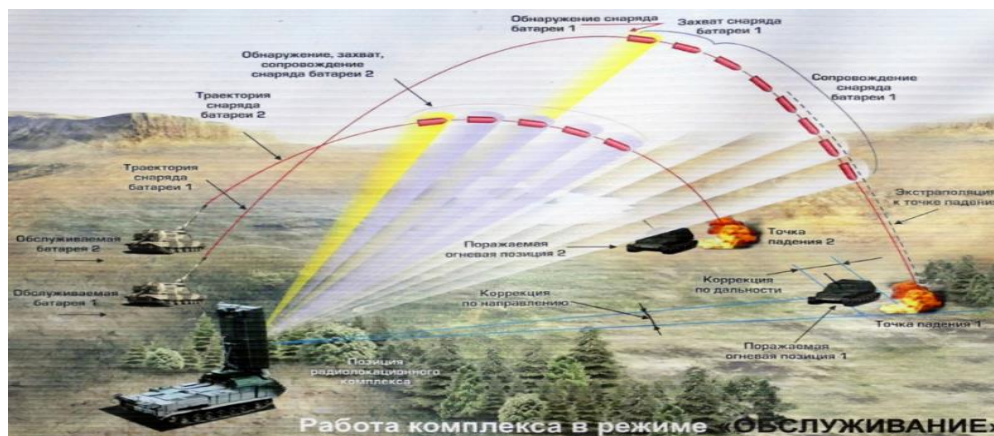
Рис. 1. Работа РЛС 1Л261 «Зоопарк-1М» в режиме обслуживания стрельбы
