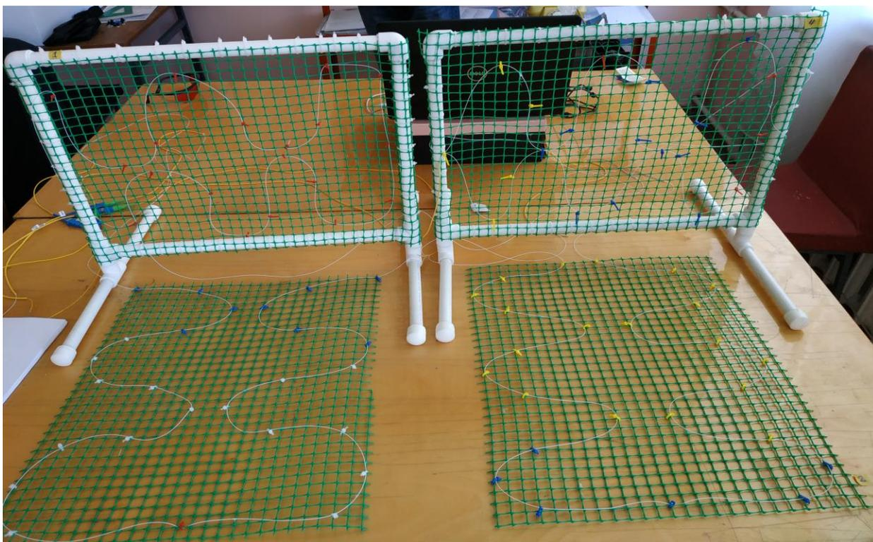
при изменениях температуры имеет использование в качестве сенсора многомодового волокна.
