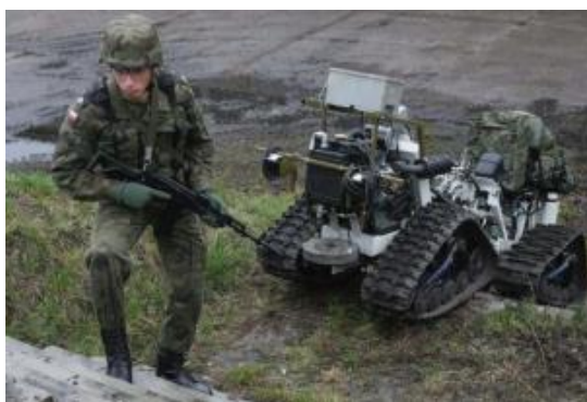
Рисунок 2. Беспилотное наземное транспортное средство (БНТС) используемое для облегчения перемещения боевой нагрузки военнослужащего при ведении боевых действий [3].
