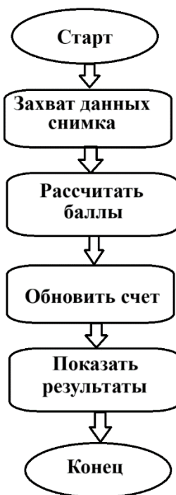
Рисунок 2. Блок-схема системы подсчета очков за стрельбы.
