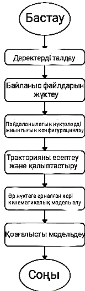
Сурет 5. Траекторияны жоспарлау және жол нүктелерін бақылау үшін модельдеу процедуралары
