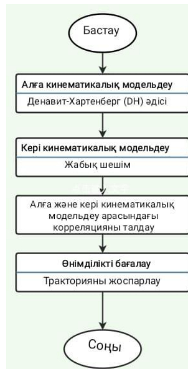
Сурет 3. Кинематикалық модельдеу процесінің блок-схемасы
